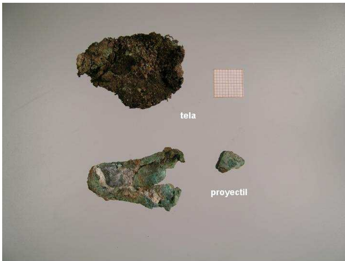
Figura 62. Proyectoil de arma de fuego de fusil fragmentado y porción de tela que lo envolvía.
