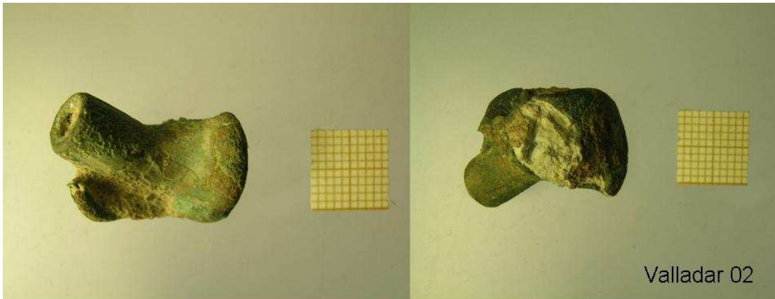
Proyctil de arma de fuego de fusil Mauser de calibre 7 mm. Deformado por impacto.
