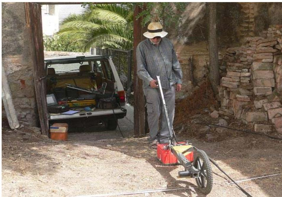
*Figura 94: Adquisición de un perfil radar con una antena de 400 MHz, diseñada para explorar a buen detalle los primeros 2-3 metros de profundidad*
