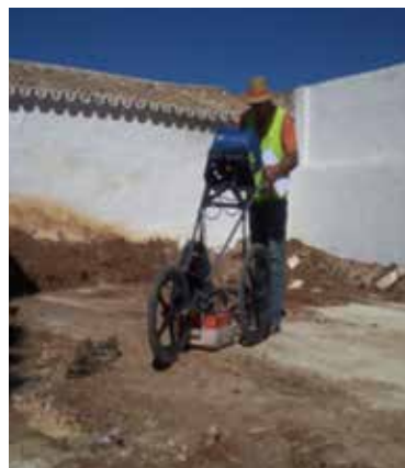
Detalle de la máquina de georadar. Fotografía del 3 de abril de 2008. Abajo: planos de los resultados de la prospección geofísica realizada en los que se indican en rojo las posibles zanjas. El georadar detectó y posicionó 1 y 2 trincheras con material osteológico en su interior a una profundidad de 1,5 m. y una tercera anomalía, la nº 3, asociable a posible fosa, pero con menor definición de contenido interno. Aranzadi. Marzo 2008.
